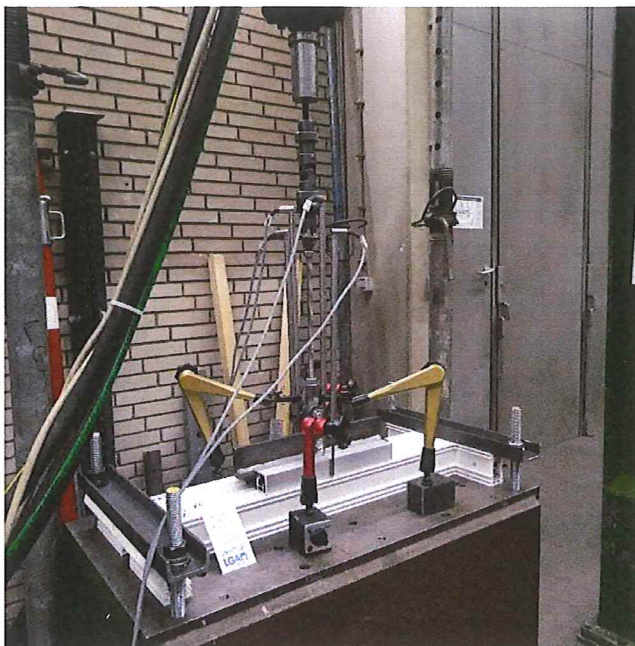
Bild 3.11 Versuchsaufbau / Anordnung der Weg- Aufnehmer / Systemtragfähigkeit
