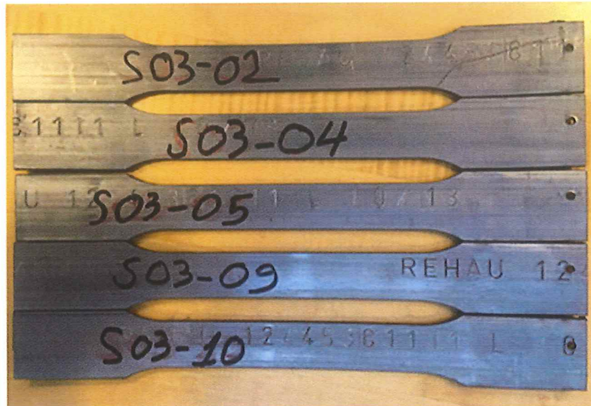
Bild 4.13 Mit Wasserstrahlschneiden aus den Einschieblingen der Probekörper hergestellte Normproben
