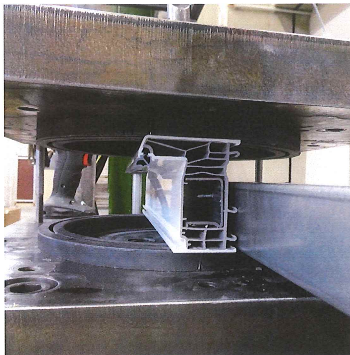
Bild 3.7 Versuchsanordnung zentrischer Zug Lage des Probekörpers – Anschlag hinten
