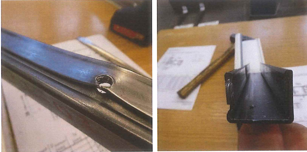
Bild 4.5 Fehlerhaft eingebauter Einschiebling bei dem Versuch PK03-03
