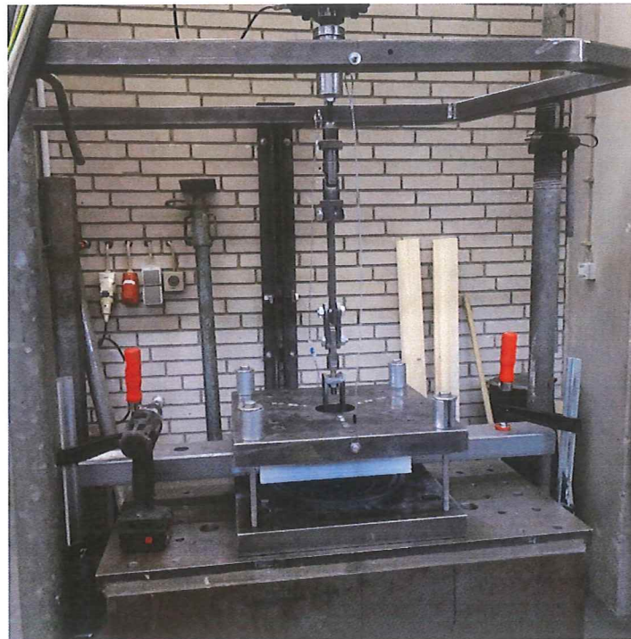
Bild 3.6 Versuchsanordnung zentrischer Zug / Ansicht
