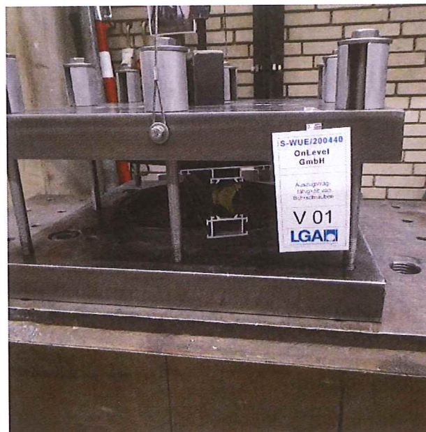
Bild 1.2. Versuchsanordnung zentrischer Zug Lage des Probekörpers
