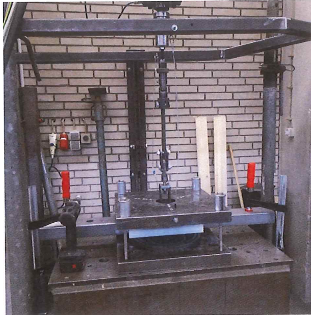
Bild 1.1.: Versuchsanordnung zentrischer Zug / Ansicht
