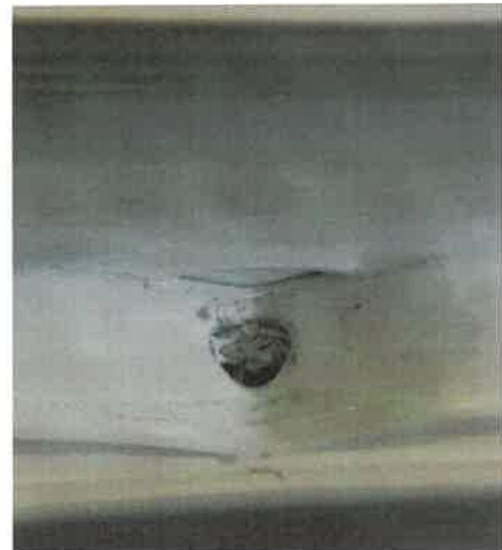
Bild 3.3: Verformungen des Kunststoffs im Bereich der Lasteinleitung
