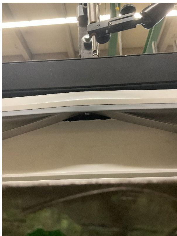
Abbildung V 08-3 Im Versuchsaufbau hinterer Kunststoffrahmen, Versagensart wie V01
