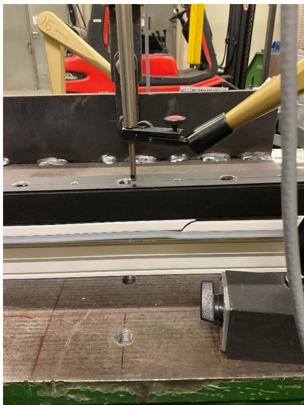
Abbildung V 02-3 Versagen des Kunststoffrahmens in Querrichtung zum Profil.
