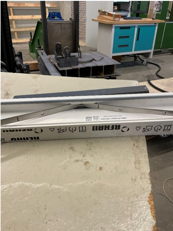
Abbildung V 09-3 Im Versuchsaufbau vorderer Kunststoffrahmen, Versagensart wie V01
