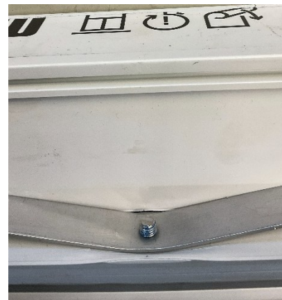
Bild 3.3: Verformungen des Kunststoffs bei Bruchlast im Bereich der Lasteinleitung.
