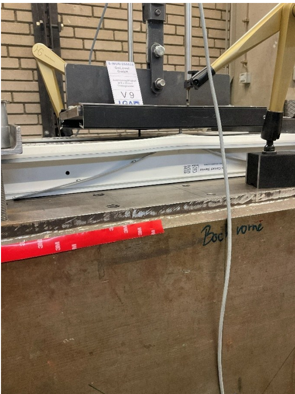
Abbildung V 09-2 Beidseitiges Versagen des Kunststoffrahmens
