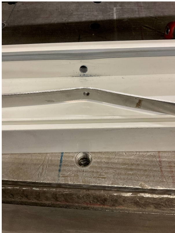
Abbildung V 10-5 Im Versuchsaufbau hinterer Kunststoffrahmen, Versagensart wie V01
