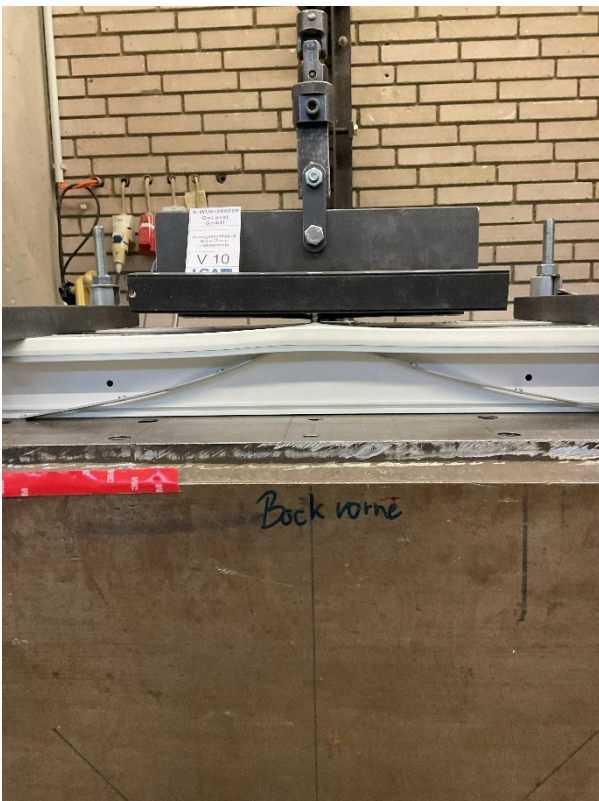
Abbildung V 10-2 Beidseitiges Versagen des Kunststoffrahmens
