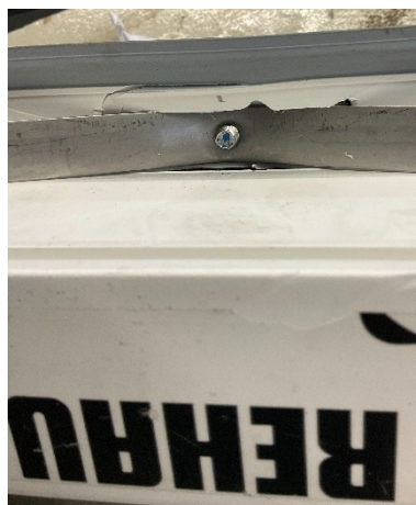
Bild 3.1 Versagensart V06 Synego 72 AD Puls
