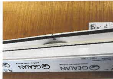
Bild 3.5: Versagensbild für F_{\text{Trag}}
