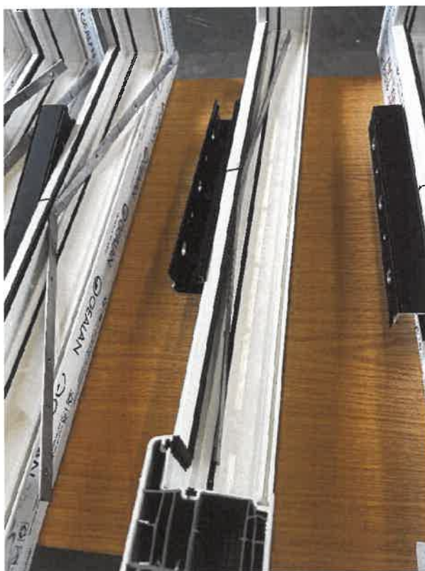
Abbildung V 05-6 bleibende Verformung der Stahlleiste von DEF 2
