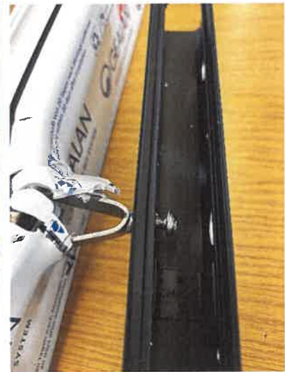
Bild 3.3 V02 und V03, Kunststoffprofil versagt
