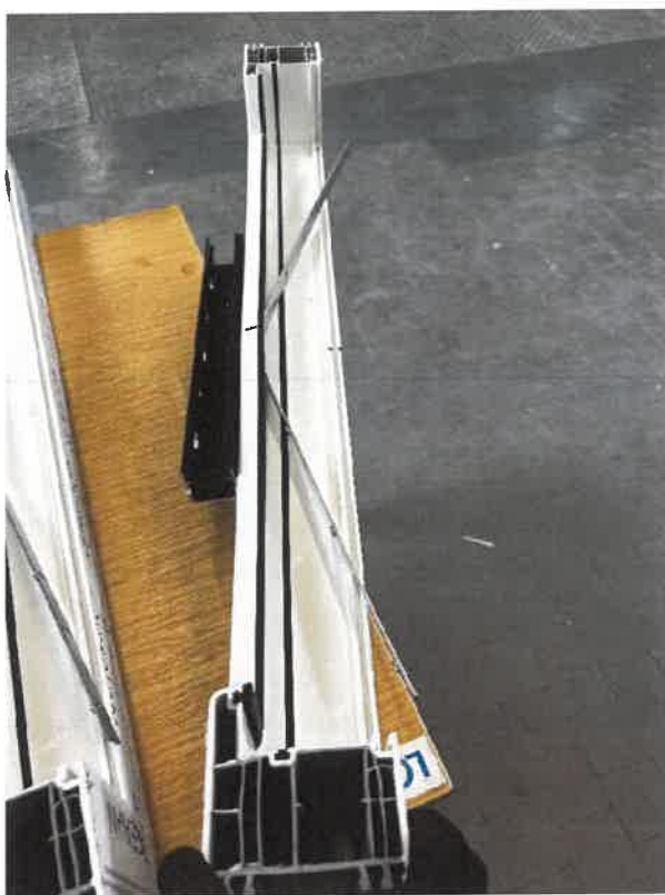
Abbildung V 06-5 bleibende Verformung der Stahlleiste von DEF 1/2
