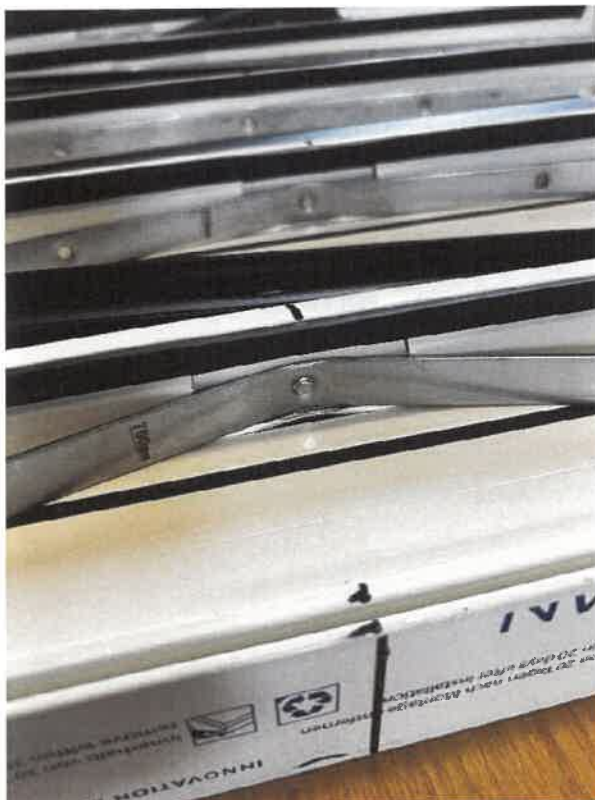
Abbildung V 06-4 Kunststoffprofil bei DEF1 versagt bei Versuchslast P_{\text{Trag}} = 6,43/2 = 3,22 \text{ kN}
