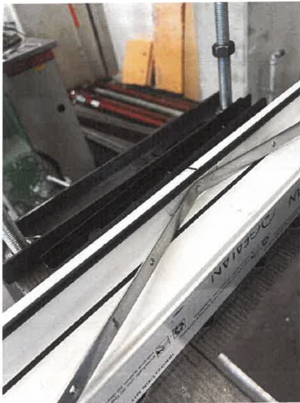
Abbildung V 06-3 Detail – Kunststoffprofil bei DEF2 versagt bei Versuchslast P_{\text{Trag}} = 6,43/2 = 3,22 \text{ kN}
