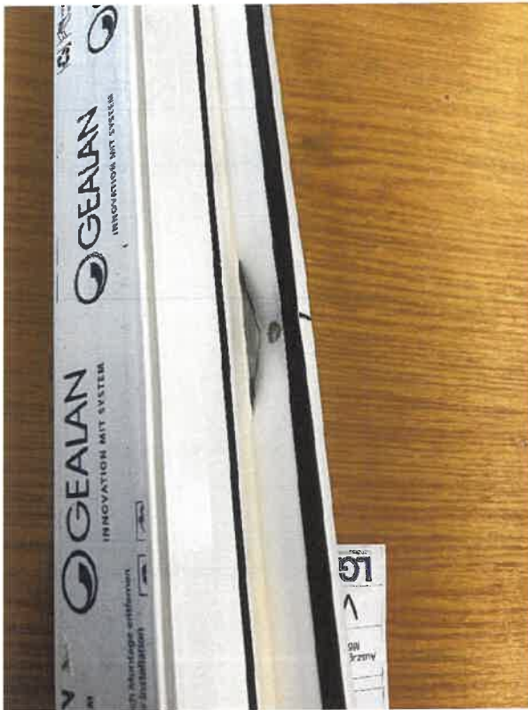
Abbildung V 01-5 Plastische Verformung des Profils bei ca. 6,2 kN
