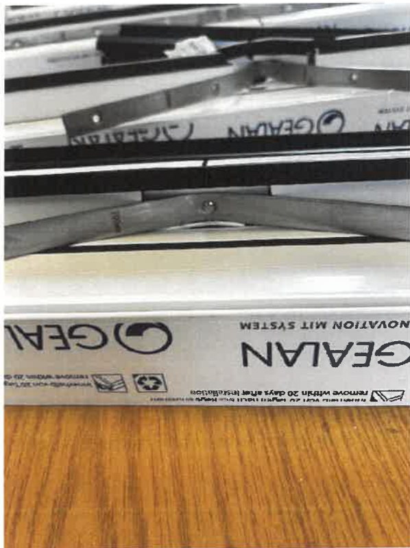
Abbildung V 04-3 Kunststoffprofil bei DEF1 versagt bei Versuchslast P_{\text{Trag}} = 6,54/2 = 3,27 \text{ kN}
