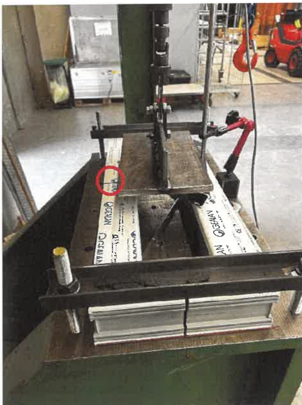
Abbildung V 01-4 Versagen der Schraube und Fließgewinde bei Laststeigerung
