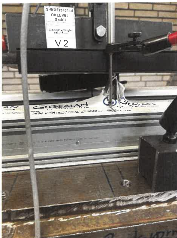
Abbildung V 02-5 Versagen der Kunststoffprofile bei 9.06 kN
