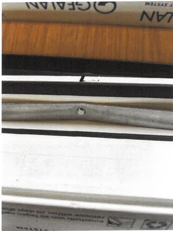
Abbildung V 05-3 Kunststoffprofil bei DEF1 kein Versagen bei Versuchslast P_{\text{Trag}} = 6,93/2 = 3,47 \text{ kN}
