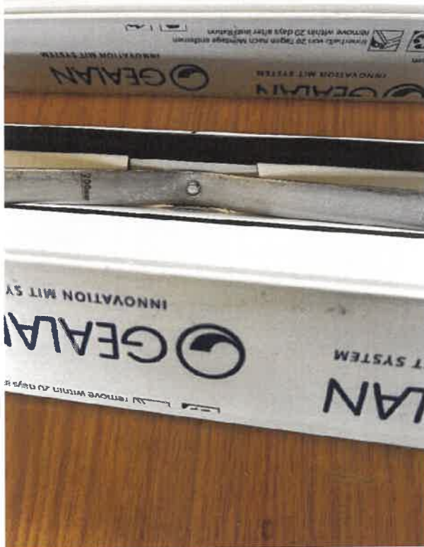
Abbildung V 05-4 Kunststoffprofil bei DEF2 versagt bei Versuchslast P_{\text{Trag}} = 6,93/2 = 3,47 \text{ kN}
