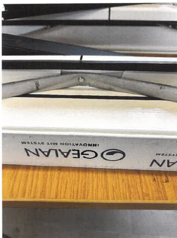
Abbildung V 04-4 Kunststoffprofil bei DEF2 versagt bei Versuchslast P_{\text{Trag}} = 6,54/2 = 3,27 \text{ kN}
