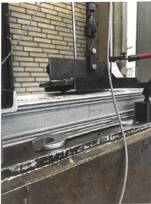
Abbildung V 01-3 Profil hebt sich vom Rahmen bei ca. 5 kN ab
