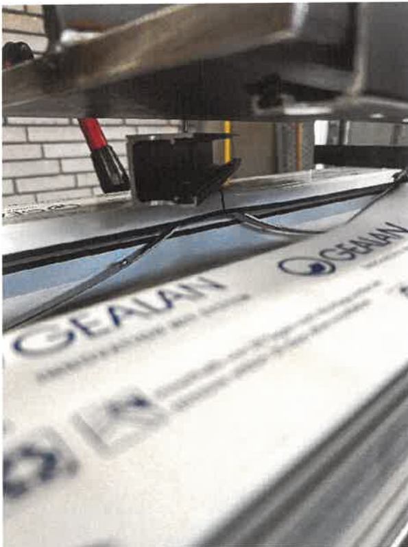
Abbildung V 02-4 Versagen der Kunststoffprofile bei 9.06 kN
