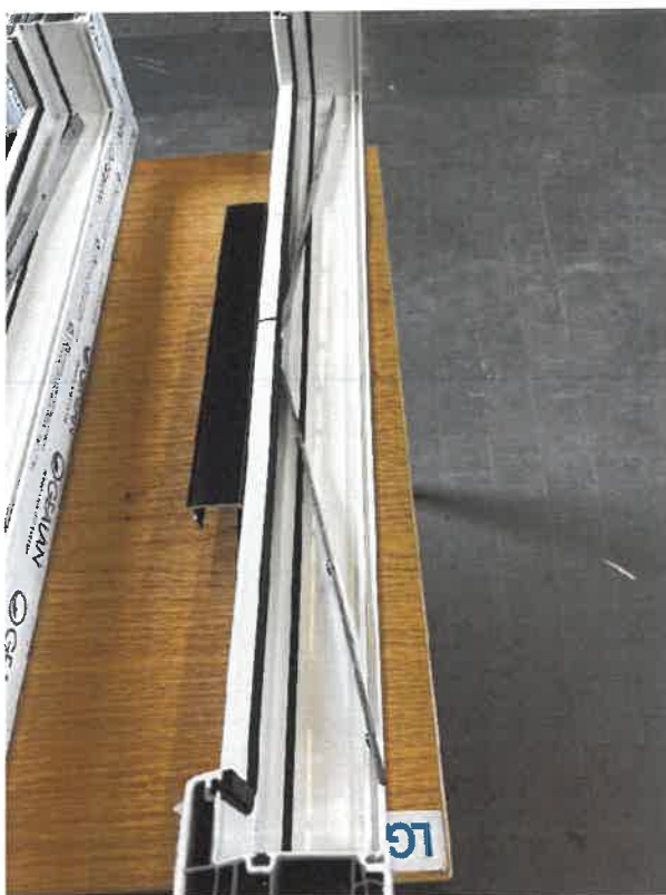
Abbildung V 05-5 bleibende Verformung der Stahlleiste von DEF 1
