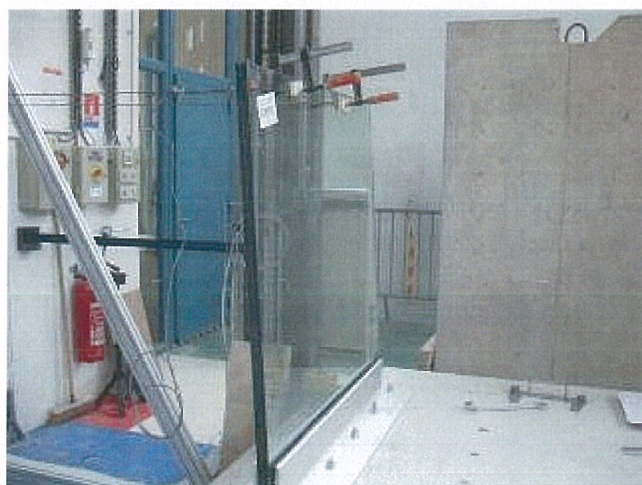
Essai de sécurité avec 3 fois la charge d'exploitation pendant 15 mn. Choc mou au sac M50/900J
