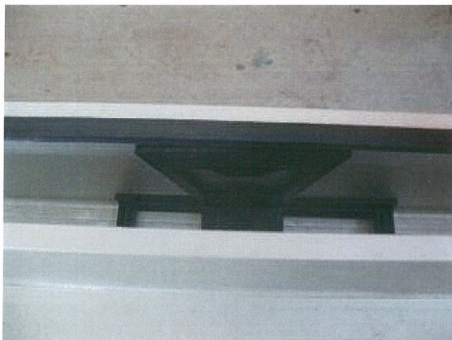
Mise en place de la cale à vitrage dans le profil et essai vers l'intérieur avec 20 daN pendant 3 mn.
