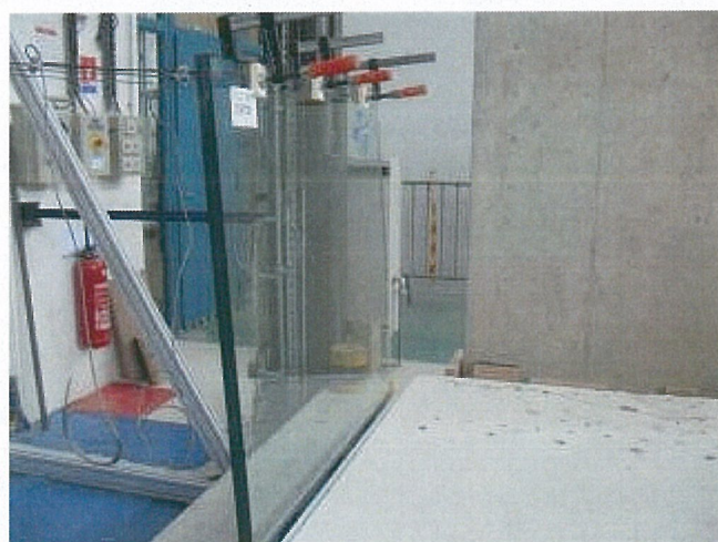
15 mn avec 3 fois la charge d'exploitation et choc mou au sac de 50 kg M50/700J
