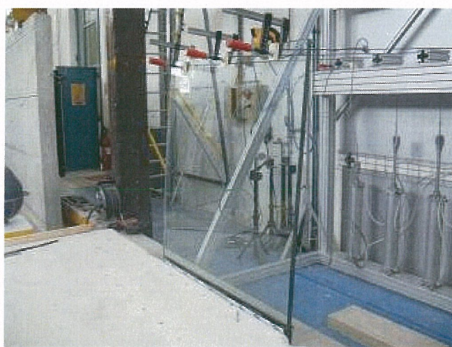
Essai statique vers l'extérieur et essai de sécurité pendant 15 minutes avec 3 fois la charge
