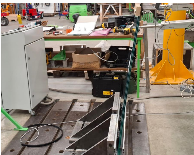
Garde-corps sollicité par la charge de sécurité
